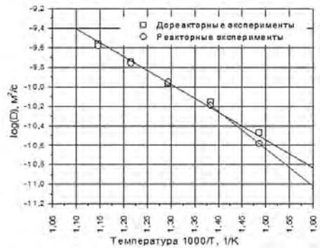
Рис. 8. Температурные зависимости коэффициента диффузии в нержавеющей стали SS316 IG
