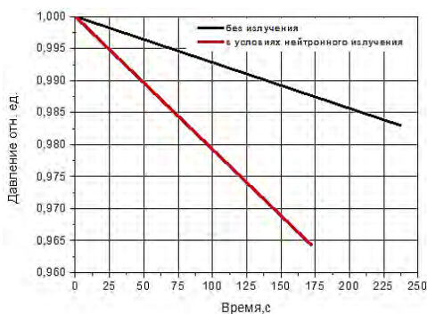
Рис. 10. Нормированный график изменения давления водорода в ампульном устройстве при температуре образца 200 °С, при уровне давления 130 Па и мощности реактора 3 МВт
