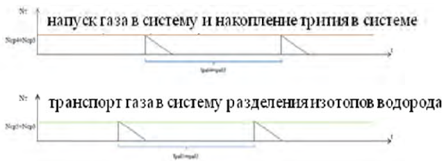
Рис. 10. Временная диаграмма работы системы переработки сверхтяжеловодных соединений
