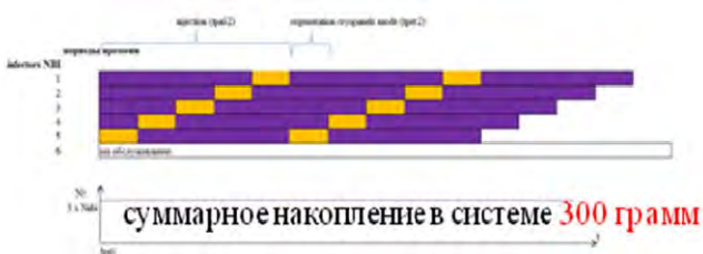
Рис. 5. Временная диаграмма режима работы системы нейтральной инжекции
