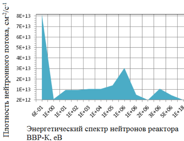
Рис. 1. Плотность нейтронного потока от энергетического спектра нейтронов реактора ВВР-К
