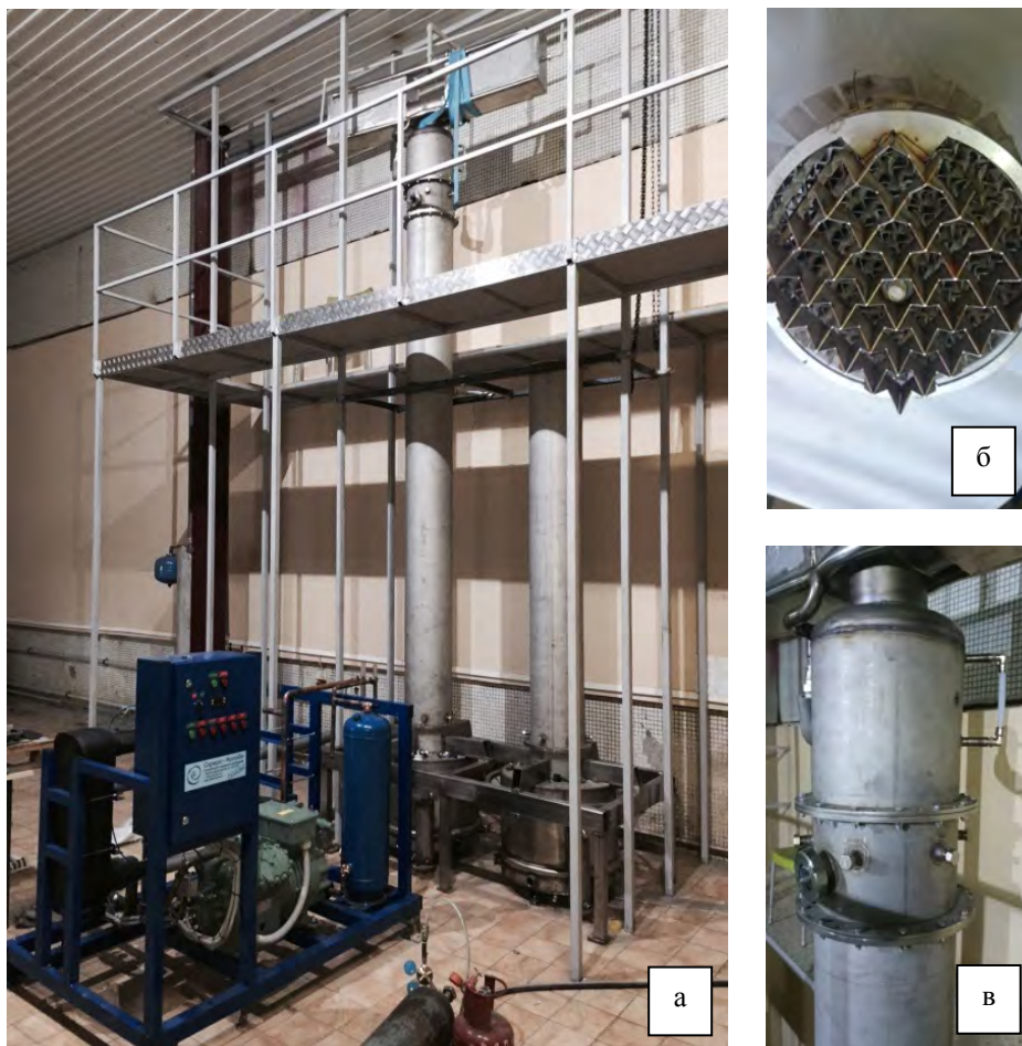
Рис. 6. Изображение лабораторной установки и ее отдельных частей: а – внешний вид; б – опорная решетка царги колонны, в – верхняя часть колонны
