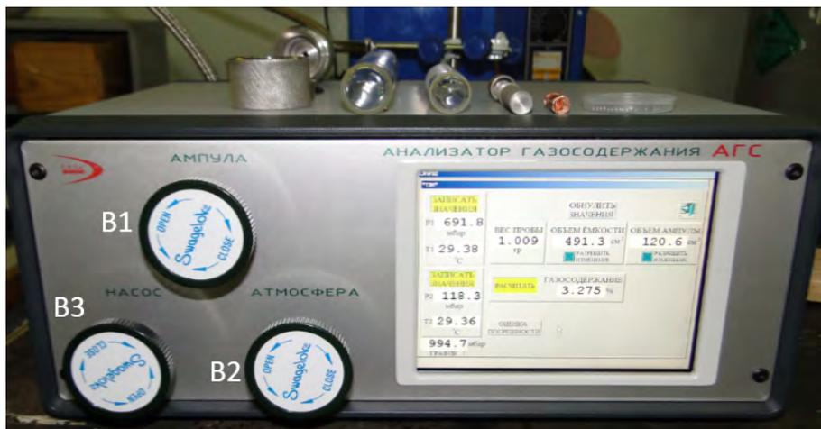
Рис. 2. Внешний вид АГС (передняя панель)
