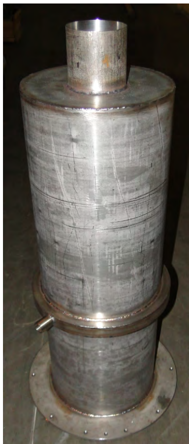
Рис. 9. Модифицированная система обдува внутреннего кожуха печного колпака: 1 – рассека-тель потока воздуха, 2 – воздушный канал, 3 – отверстия для прохождения воздуха
