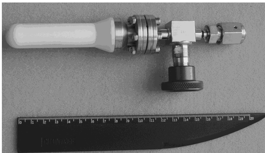
Рис. 2. Фотография ловушки для хранения трития с корпусом, изготовленным из алюмооксидной керамики методом изостатического прессования
