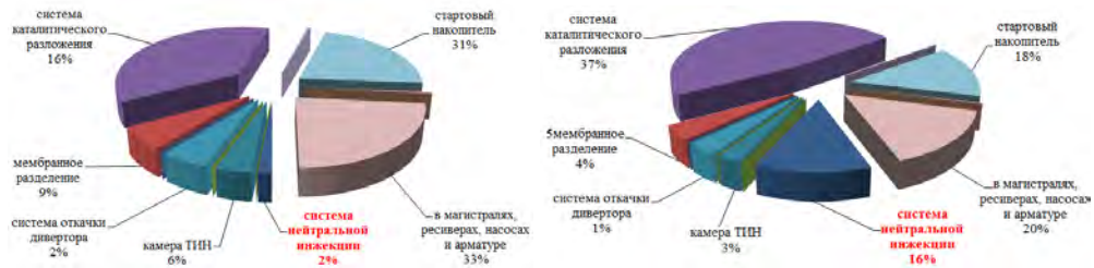
Рис. 4. Распределение накопленного трития между системами ТЦ для вариантов использования в качестве газовой смеси D:T=1:0 (слева) и D:T=1:1 (справа) в системе нейтральной инжекции
