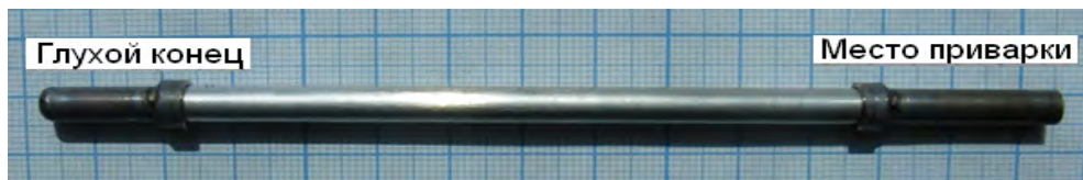
Рис. 1. Образец трубчатой мембраны из сплава V-Pd с палладиевым покрытием внешней и внутренней сторон
