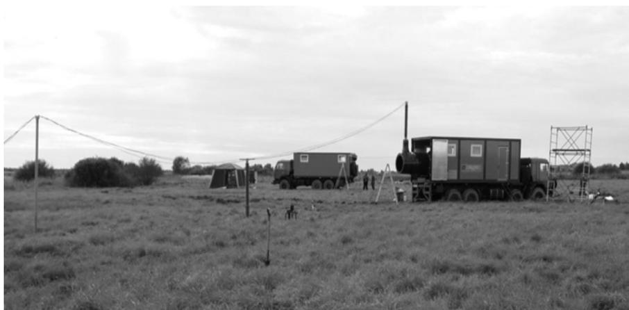
Рис. 4. Схема эксперимента (а) и фото полевых испытаний МИК ВМГ (б). Обозначения: 1 – генератор тока молнии; 2 – автомобиль управления; 3 – штанга ввода тока; 4 – контур ввода тока (1 – сплошная линия,  $15 \times 15$  м,  $R = 2$  Ом), (2 – пунктирная линия,  $4 \times 4$  м,  $R = 4$  Ом); 5 – контур заземления; 6 – делитель № 1; 7 – делитель № 4; 8 – делитель № 3; 9 – делитель № 2; 10 – пояса Роговского ПР3, ПР4; 11 – пояса Роговского ПР1, ПР2
