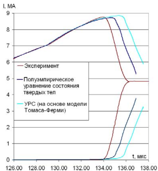
Рис. 2. Временные зависимости тока в цепях генератора и нагрузки в расчетах кумулятивного ВРТ с различными УРС для полиэтилена
