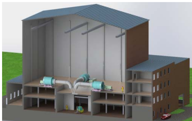
Рис. 1. Электрофизическая установка «Гамма-4» в специально спроектированном здании
