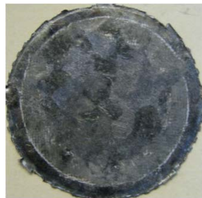
Рис. 5. Свинцовая пластина после воздействия электронным пучком (след от пучка электронов обозначен стрелкой): а – острый катод, б – катод в виде полого цилиндра
