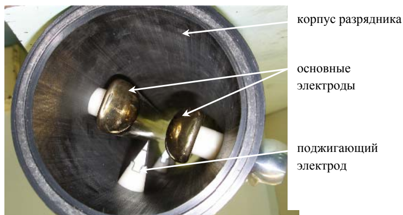
Рис. 1. Внутреннее устройство высоковольтного рельсового коммутирующего разрядника
