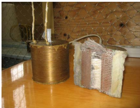
Рис. 1. Соленоид сильных магнитных полей целый и в разрезе
