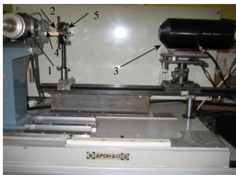
Рис. 2. Фотография макета рентгеновского микроскопа
