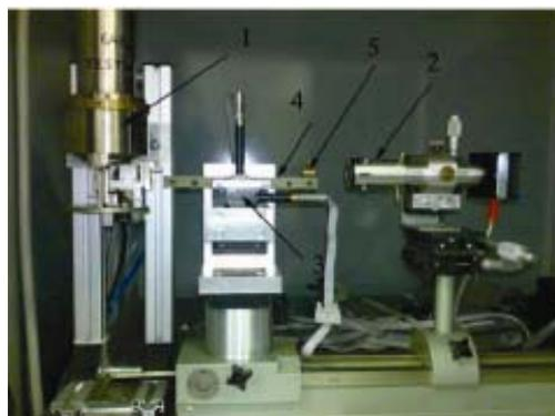
Рис. 4. Фотография рентгенооптического стенда для исследования оптических параметров рентгеновского пучка. 1 – микрофокусная рентгеновская трубка, 2 – рентгеновская ПЗС-камера, 3 – гониометр, 4 – держатель для размещения линзы, 5 – преломляющая рентгеновская линза в оправе
