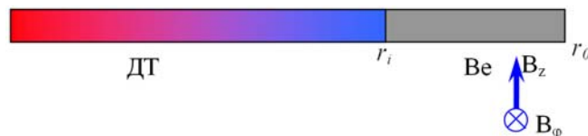
Рис. 2. Разрез мишени с Be-лайнером
