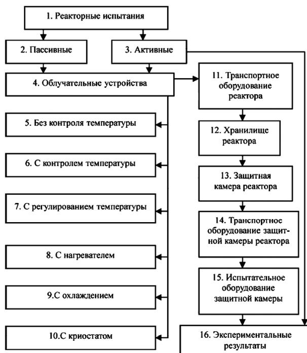
Рис. 1. Стадии получения экспериментальных результатов при пассивных и активных реакторных испытаниях и пример классификации ОУ по способам достижения заданной температуры
