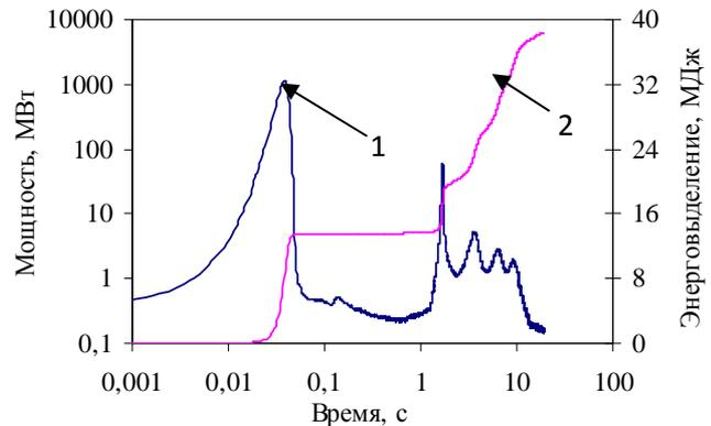
Рис. 3. Форма пуска, генерированного с задержкой извлечения групп импульсных стержней друг относительно друга в 1,5 секунды: 1 – мощность; 2 – энерговыделение
