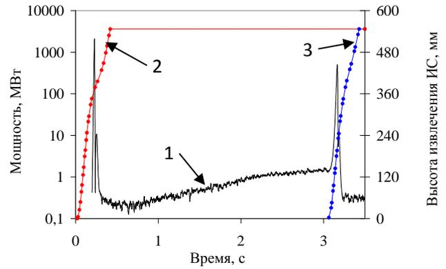
Рис. 2. Форма пуска, генерированного с задержкой извлечения групп импульсных стержней друг относительно друга в 3 секунды: 1 – мощность, 2 – высота извлечения ИС-1; 3 – высота извлечения ИС-2
