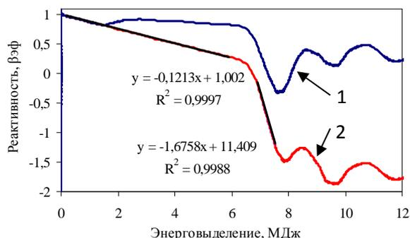
Рис. 6. Зависимость реактивности АЗ от энерговыделения (для пуска, изображённого на рисунке 5): 1 – реактивность АЗ; 2 – реактивность АЗ без учёта реактивности, вносимой ИС-2 (реактивность, внесённая ИС-1 ещё до начала развития квазиимпульса равна  $1,00 \beta_{эф}$ )
