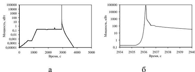
Рис. 8. Работа ИЯР ВИР-2М в режиме генерации импульса с мощности: а) полный вид, б) увеличенный фрагмент рисунка 8а (момент импульса)
