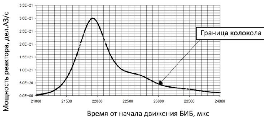
Рис. 5. Импульс делений на мгновенных нейтронах с отражателем x = 300 мм, y = 185 мм при начальной мощности 1 \cdot 10^{10} дел.АЗ/с и движении БИБ со скоростью 9 м/с
