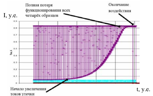
Рис. 11. Испытания микросборки с функцией реле
