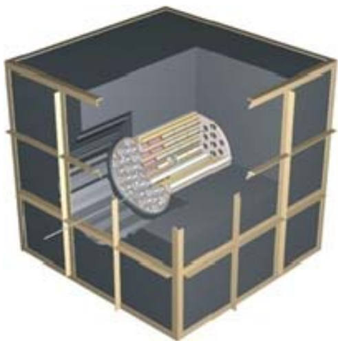
Рис. 6. Лабораторная модель бланкета на расплавленных фторидах [6]
