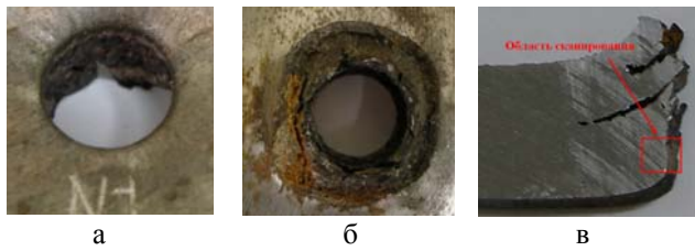
Рис. 3. Образец стали-3 после воздействия кумулятивной медной струи: а – со стороны воздействия; б – обратная сторона; в – образец для проведения анализа
