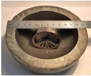
Рис. 4. Фотография стальной миры внутри детали из ВНЖ
