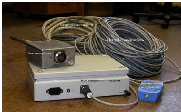
Рис. 8. Общий вид системы контроля энергии пучка ускорителя
