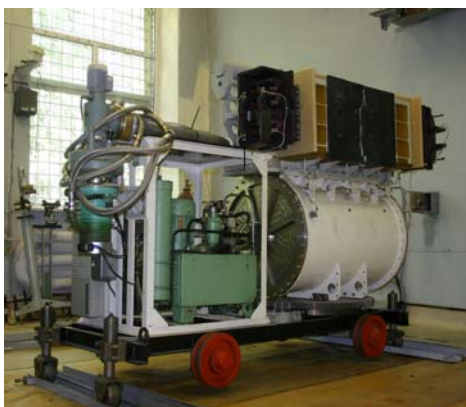
Рис. 7. Лазерный модуль ЛМ-8 (а) и поперечное сечение активной зоны лазерного модуля ЛМ-8 (б)
