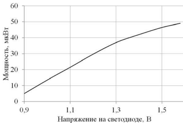
Рис. 3. Зависимости от напряжения на светодиоде HFBR-1312: а – тока светодиода, б – выходной мощности светодиодного передатчика
