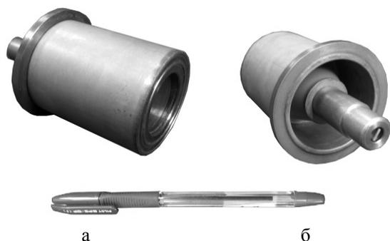
Рис. 3. Ускорительная трубка СНИТ-1000: а – вид сбоку, б – вид сзади
