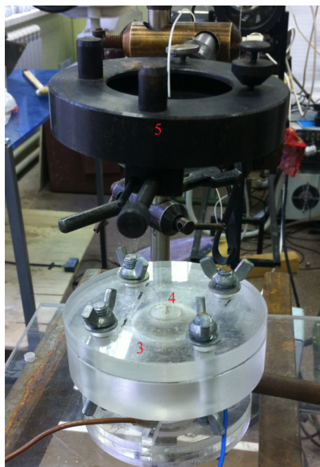
Рис. 2. а) Схема и б) фотография экспериментальной сборки. Обозначения: 1 – камера, заполненная газовой смесью; 2 – искровой зазор; 3 – крышка с каналом диаметром 2 мм; 4 – канал для разгона частиц; 5 – датчик PDV; 6 – пленка
