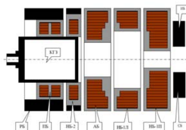
Рис. 24. Схема АЗ реактора БР-К1: КГЗ – контейнер горизонтальной загрузки; РБ – регулирующий блок; ПБ – подвижный блок; АБ – аварийный блок; НБ-2 – второй неподвижный блок; АБ – аварийный блок; НБ-1Л – 1-ый неподвижный блок левый; НБ-1П – 1-ый неподвижный блок правый; ИБ, СБ – импульсный блок и стоп-блок
