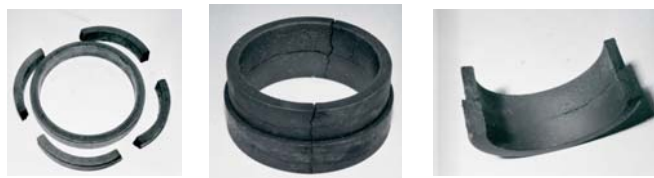
Рис. 13. Разрушенные топливные элементы реактора БР-1 нере ЦК с размерами: \varnothing 9,4 см, высота 30 см
