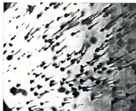
Рис. 6. Фотография повреждений в иртране-4, возникающих после облучения (реактор ВИР-2, D_\gamma = 5 \cdot 10^3 Гр, нейтронный флюенс - 2 \cdot 10^{15} см ^{-2} ). Увеличение - 50 раз
