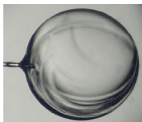
Начало кристаллизации T_A = 15,81 \text{ К}, T_B = 16,74 \text{ К}
