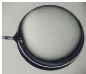
Начало конденсации T_A = 16,05 \text{ К}, T_B = 16,97 \text{ К}
