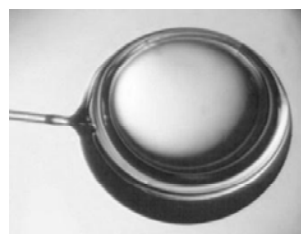
Начало кристаллизации, T_A = 18,47 \text{ К}, T_B = 19,27 \text{ К}
