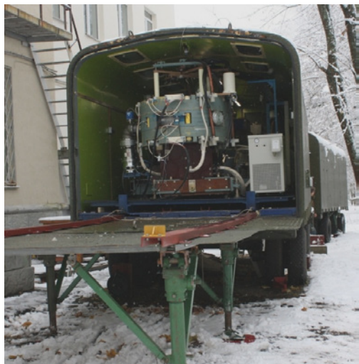
Рис. 3. Мобильный циклический ускоритель: 1 – ускорительный модуль; 2 – модуль импульсного питания электромагнита
