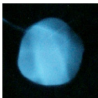
Рис. 5. Фотография свечения полиметилметакрилата. Диаметр светящейся области 6 мм. Амплитуда тока пучка 220 А
