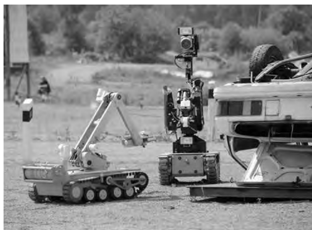
Рис. 5. Проведение инженерной разведки с использованием робототехнических комплексов
