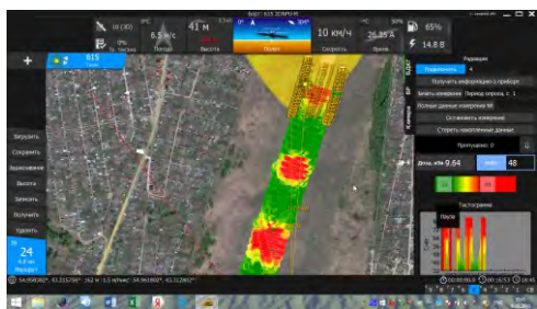
Рис. 9. Отображение радиометрической информации, зарегистрированной с борта БЛА «Орлан-К6»
