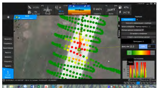
Рис. 10. Отображение радиометрической информации в виде окрашенных точек на маршруте полета БЛА «Орлан-К6»
