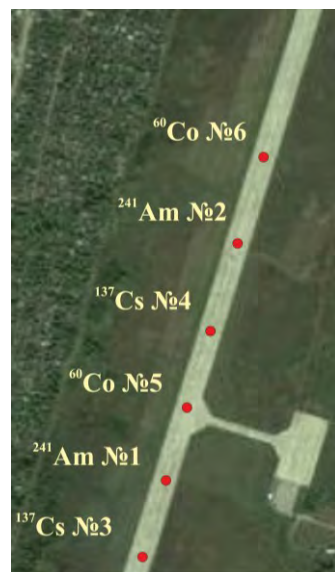
Рис. 4. Схема расположения ИИИ на ВПП аэродрома (номера ИИИ из табл. 3)
