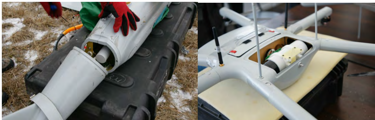
Рис. 3. Детекторы БДКГ-03 (слева) и БДКГ-04
