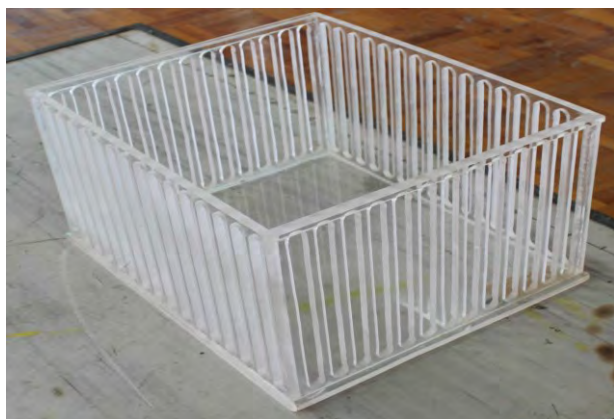
Рис. 1. Контейнер для размещения животных во время воздействия ЭМИ
