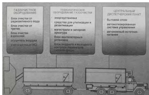
Рис. 14. Компонновка установки МАУГОС
