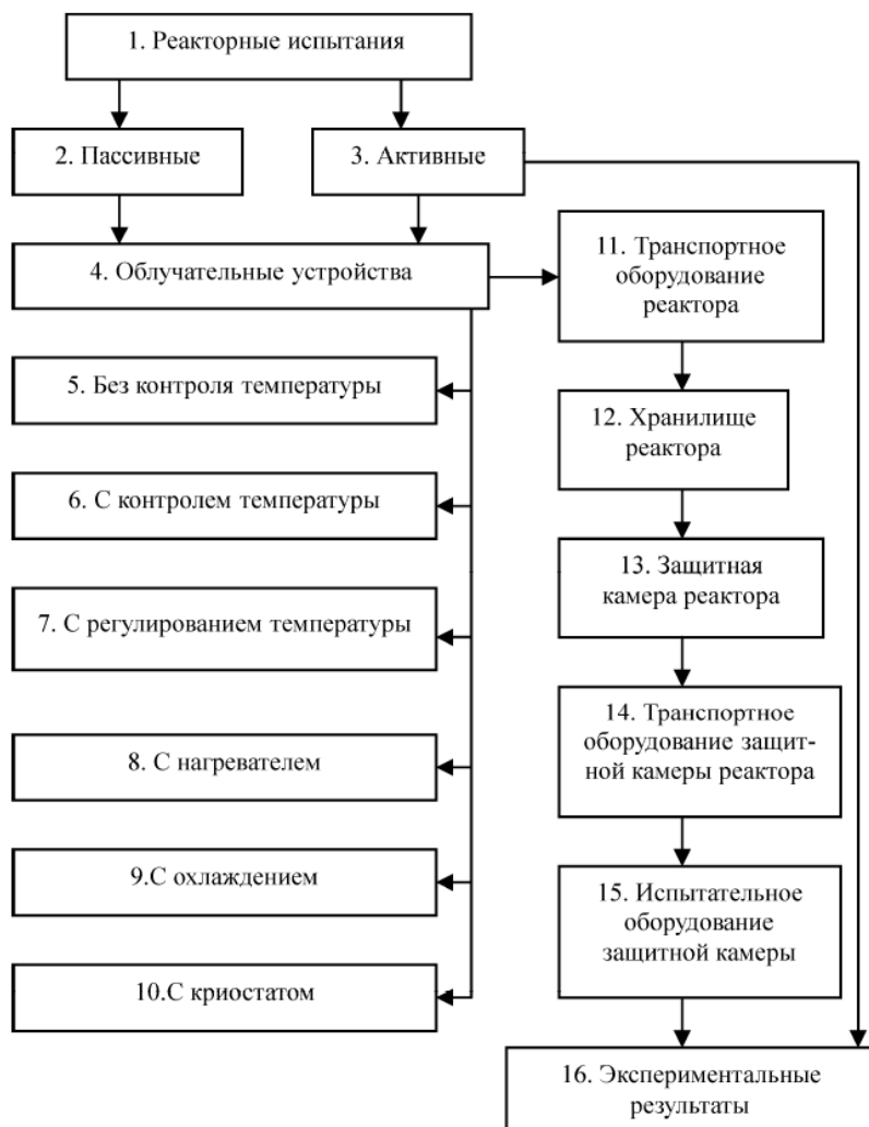
Рис.1. Стадии получения экспериментальных результатов при пассивных и активных реакторных испытаниях и пример классификации ОУ по способам достижения заданной температуры
