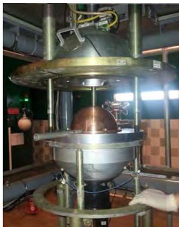
Рис. 1. Схема стенда реактора ПРИЗ-М: 1 – опорная плита реактора; 2 – нижний отражатель из меди; 3 – верхний отражатель из меди; 4 – механизм перемещения НБ; 5 – масляный демпфер; 6 – трубы и компрессор системы воздушного охлаждения; 7 – формирователь спектра нейтронов; 8 – стяжки (трубы) крепления верхнего отражателя; 9 – якорь механизма перемещения НБ; 10 – опора якоря; 11 – штанги крепления НБ; 12 – электромагнит механизма перемещения НБ; 13 – опоры механизма перемещения НБ
