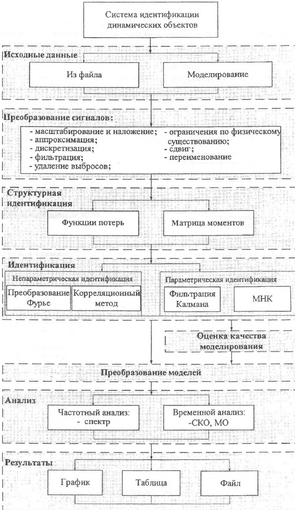
Рис. 3. Структура взаимодействия основных режимов функционирования программного комплекса "Идентификация"
