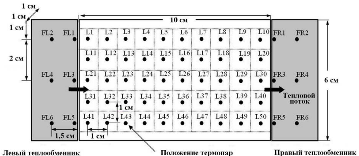
Рис. 4. Схематическое изображение тигля с двумя теплообменниками на торцах
