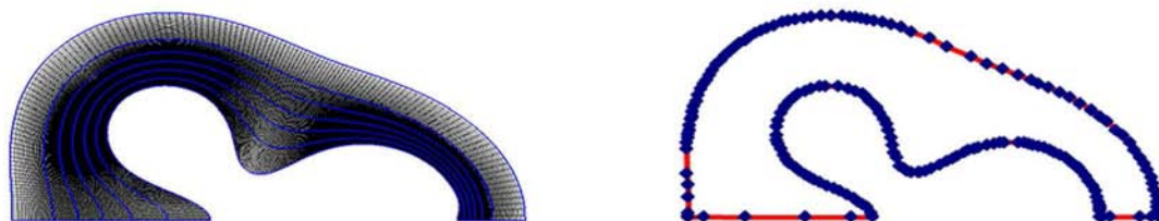
Рис. 12. Вид расчетной сетки на момент времени t = 1,1 и сравнение формы оболочки, полученной при расчетах в последовательном ( \blacklozenge ) и параллельном ( \text{—} ) режимах
