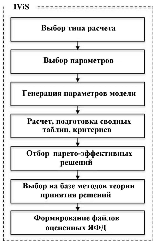
Рис. 2. Схема функционирования системы IViS SMPI
