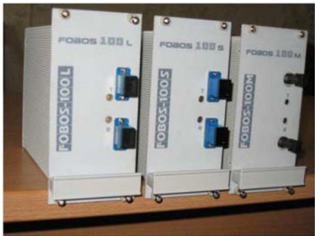
Рис. 6. Внешний вид конвертеров FOBOS-100S (L,M)
