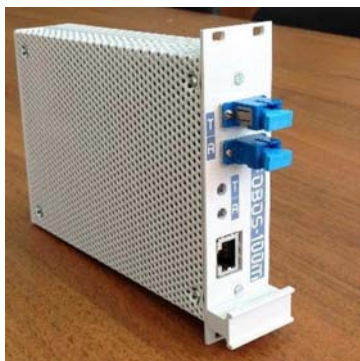
Рис. 8. Внешний вид нового конвертора FOBOS-100M
