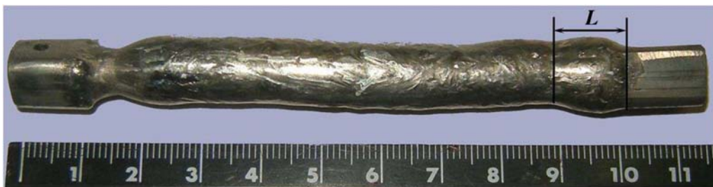
Рис. 2. Перекристаллизированный методом БЗП образец TiAl(Nb,Cr,Zr)
