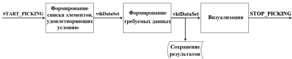
Рис. 5. Обобщенная схема отбора элементов с использованием фильтров VTK
