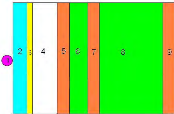
Рис. 23. Геометрия задач пробивания многослойной преграды: 1 – железо d = 13,5 мм; 2 – текстолит толщиной 15 мм; 3 – алюминий толщиной 4 мм; 4 – воздушный зазор толщиной 25 мм; 5, 7, 9 – сталь толщиной 10 мм; 6, 8 – парафин толщиной 20 и 60 мм соответственно
