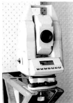
Рис. 3. Геодезические средства угломерно-дальномерных измерений: а – электронный тахеометр; б – уголкоый отражатель
