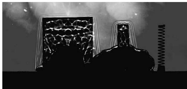
Рис. 7. Одновременное взрывное нагружение образцов из плексигласа (6,1 мкс (а), 12 мкс (б), 20,1 мкс (в), 30 мкс (г))
