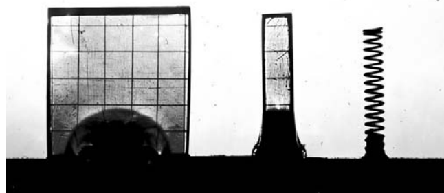
Рис. 6. Одновременное взрывное нагружение образцов из плексигласа (справа) и LiF (3,1 мкс)
