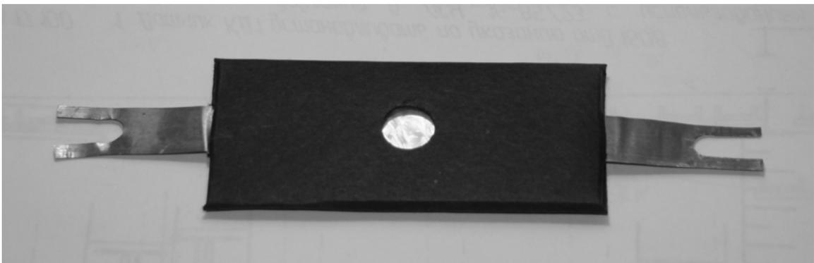
Рис. 3. Вид газоразрядного излучателя
